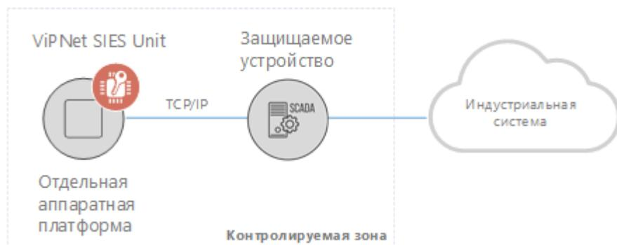
Рисунок 2. Размещение ViPNet SIES Unit на отдельной аппаратной платформе
